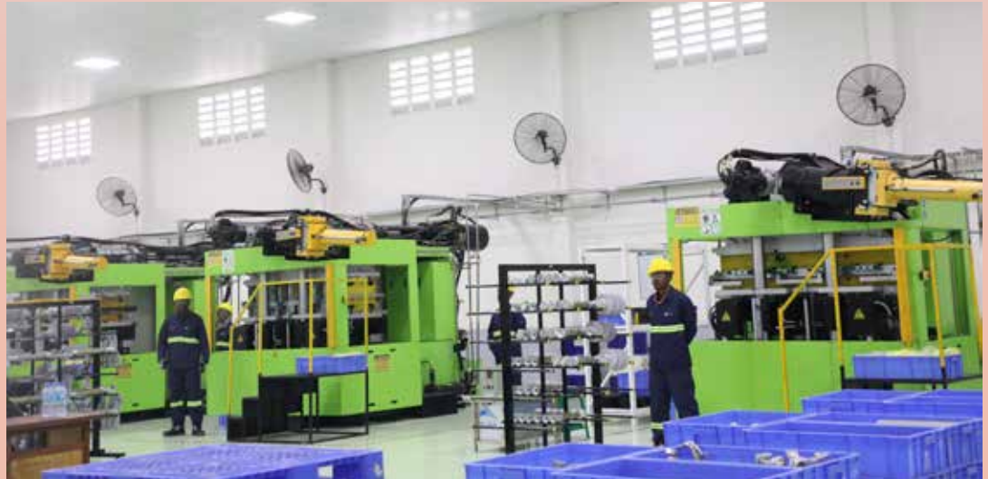
Mashine Tatu kati ya Nne zilizopo katika kiwanda cha Inhemeter ambazo hutengeneza vikombe (insulators) zinazotumika kwenye miundombinu ya usafirishaji na usambazaji umeme.
